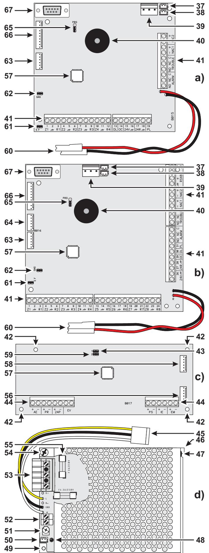
Figura 5 Identificación de Partes: a) Placa Principal (2 o 4 zonas); b) Placa Principal 8 zonas; c) Módulo Extinción; d) Fuente Alimentación conmutada de J408
