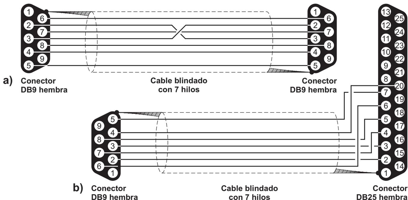
Figura 27 Diagrama de la conexión serie entre la Central y el PC
