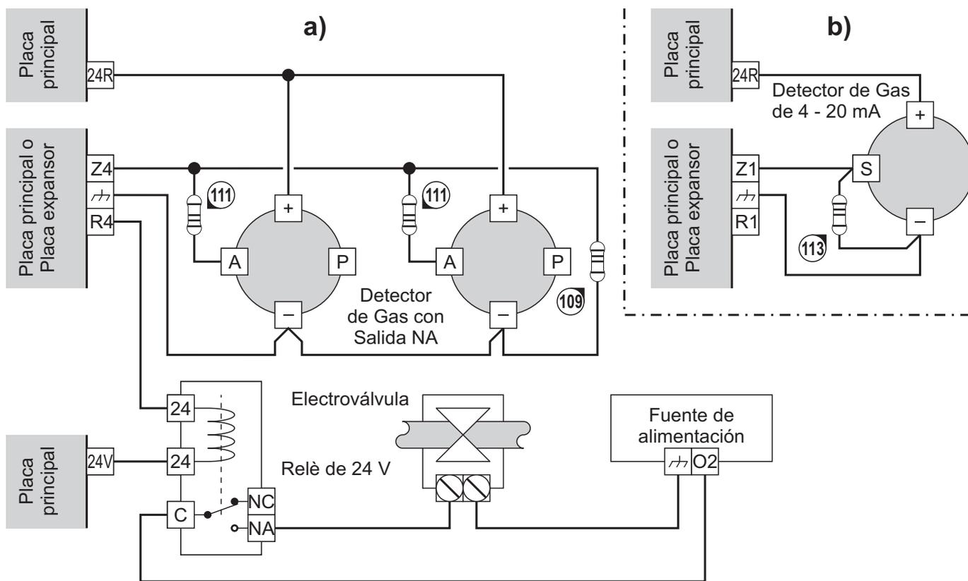
**Figura 16** Conexión de un detector de Gas con Salida Normalmente Abierta (a) y un detector de Gas de 4 - 20 mA (b): **109** Resist. Fin de Línea de 3900 ohm, 1/4 W (naranja-blanco-rojo-oro); **111** Resist. de 680 ohm; **113** Resist. 470 ohm, 2 W
