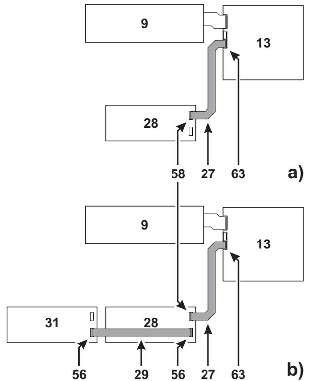
**Figura 9** Conexión de UN Módulo de Extinción (a) o DOS Módulos de Extinción (b) a la Central J424: 9) Placa de Control Principal; 13) Placa Principal; 27) y 29) cable plano para conectar los Módulos de Extinción; 28) Módulo de Extinción n°. 1; 31) Módulo de Extinción n°. 2; 56) Conector para el Módulo de Extinción consecutivo 58) Terminal para conectar a la Placa Principal; 63) Conector para el Módulo de Extinción n°. 1.
