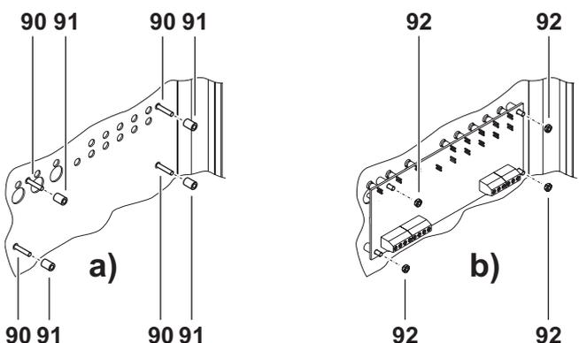
Figura 8 J424: Instalación del Módulo de Extinción
