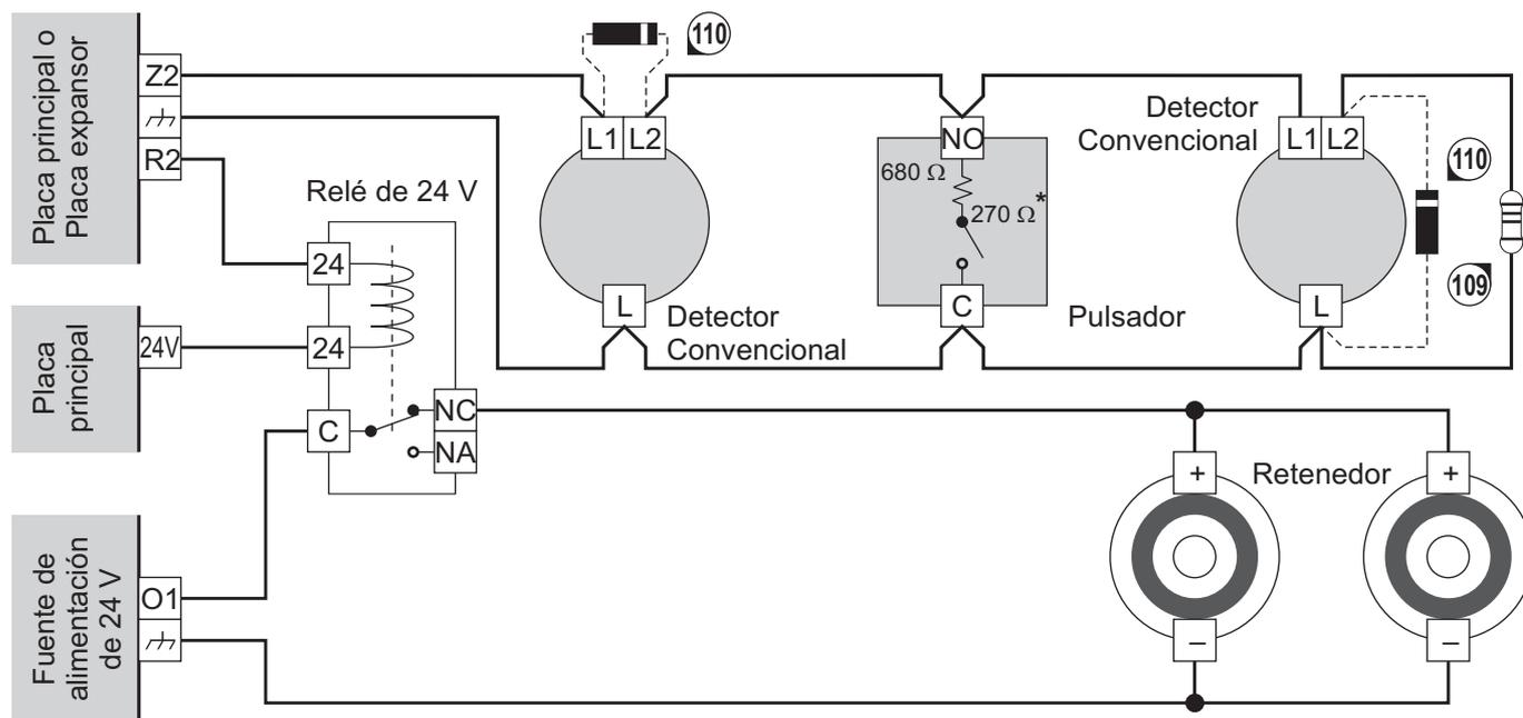
**Figura 14** Conexión de 3 equipos de detección en una zona: **109**) Resist. Fin de Línea de 3900 ohm, 1/4 W (naranja-blanco-rojo-oro); **110**) 1N5919 Diodo (o similar) — necesario si está habilitada la opción **Anular Detectores Perdidos**; \*) Resistencia del contacto del pulsador — necesaria si tiene **Pulsador Prioritario**
